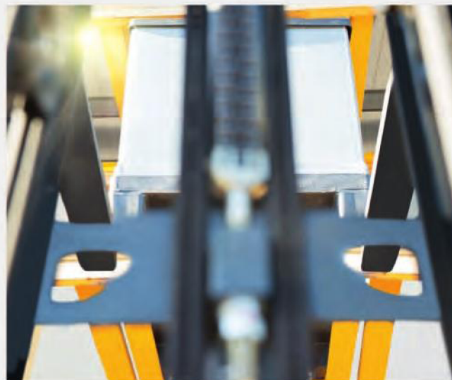
دید واضح از نوک شاخکها از طریق شیشه جلو در هنگام بالا بردن بار.
